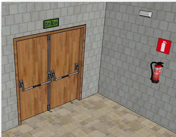
Porta de saída de emergência com placa de sinalização de saída
